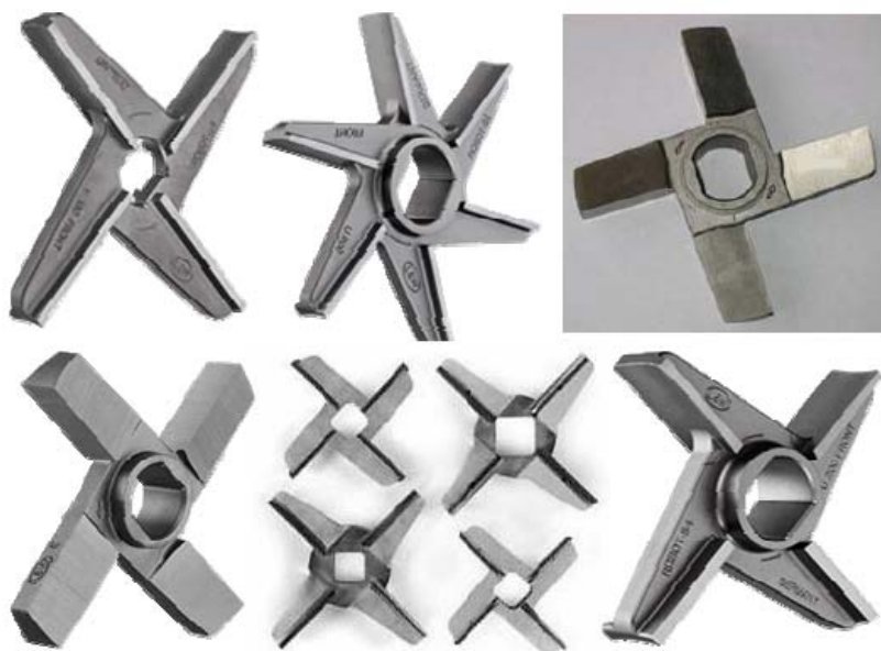
Рис. 24. Ножи, которые не перемещают продукт вдоль лезвия
