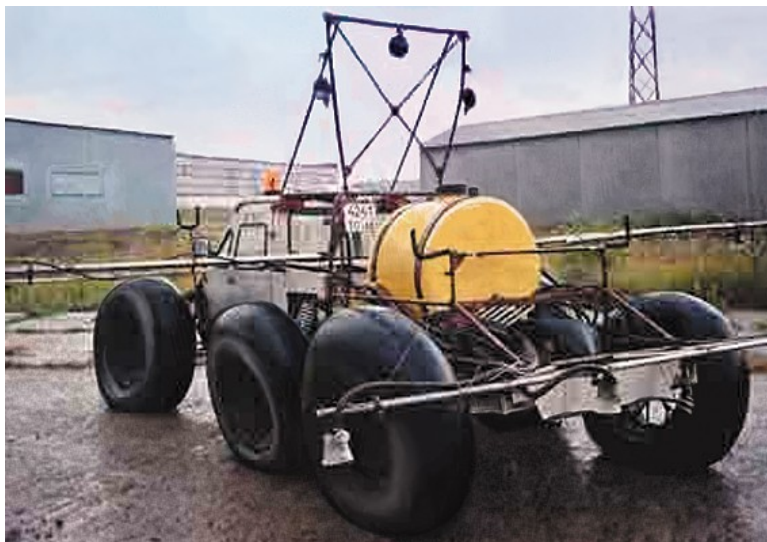
Вездеход ТТС–70 на шинах сверхнизкого давления с опрыскивателем
