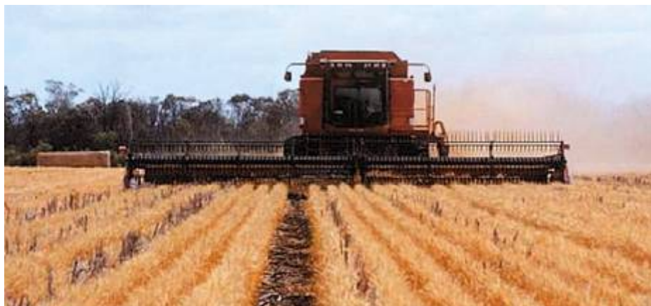
Рис. 18. Комбайн на технологической колее.
