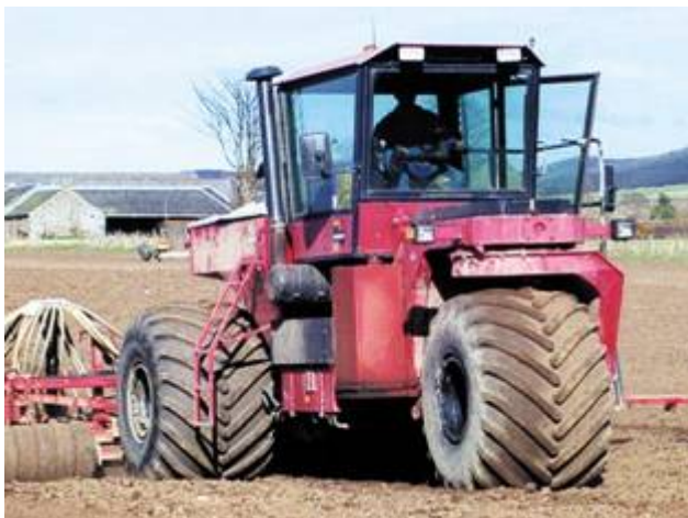
Рис. 5. Трактор с арочными шинами [8]
