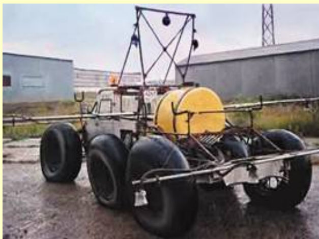
Вездеход ТТС-70 на шинах сверхнизкого давления с опрыскивателем
