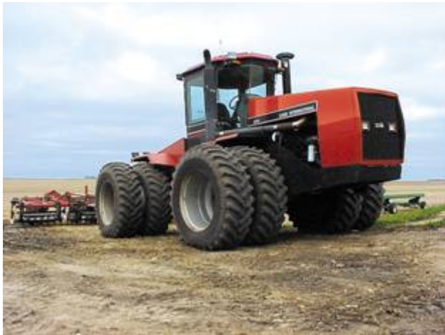
Рис. 3. Трактор со спаренными колесами [6]
