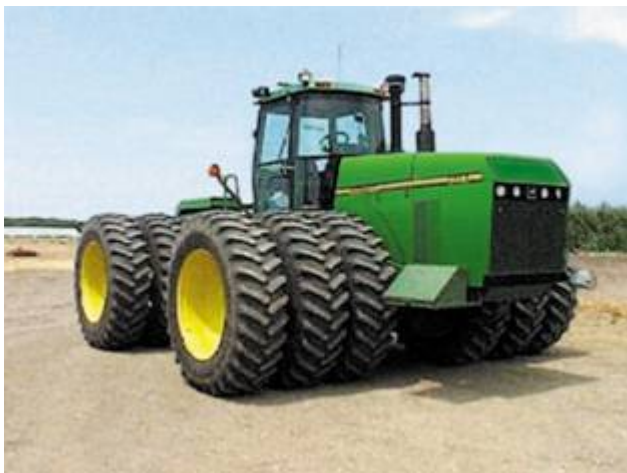
Рис. 4. Трактор со строенными колесами [7]
