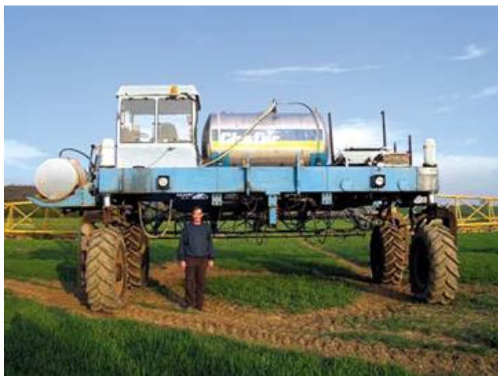
Рис. 20. Мостовой трактор с шириной пролета 5,8 метра
