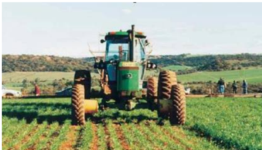
Рис. 17. Трактор с увеличенной длиной колесных осей
