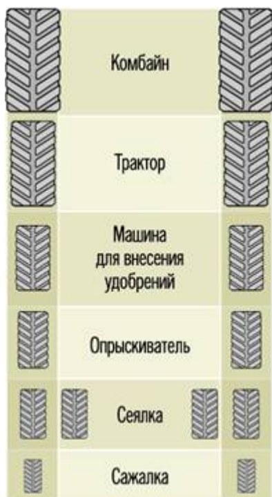
Рис. 15. Одинаковая ширина колеи для всех машин
