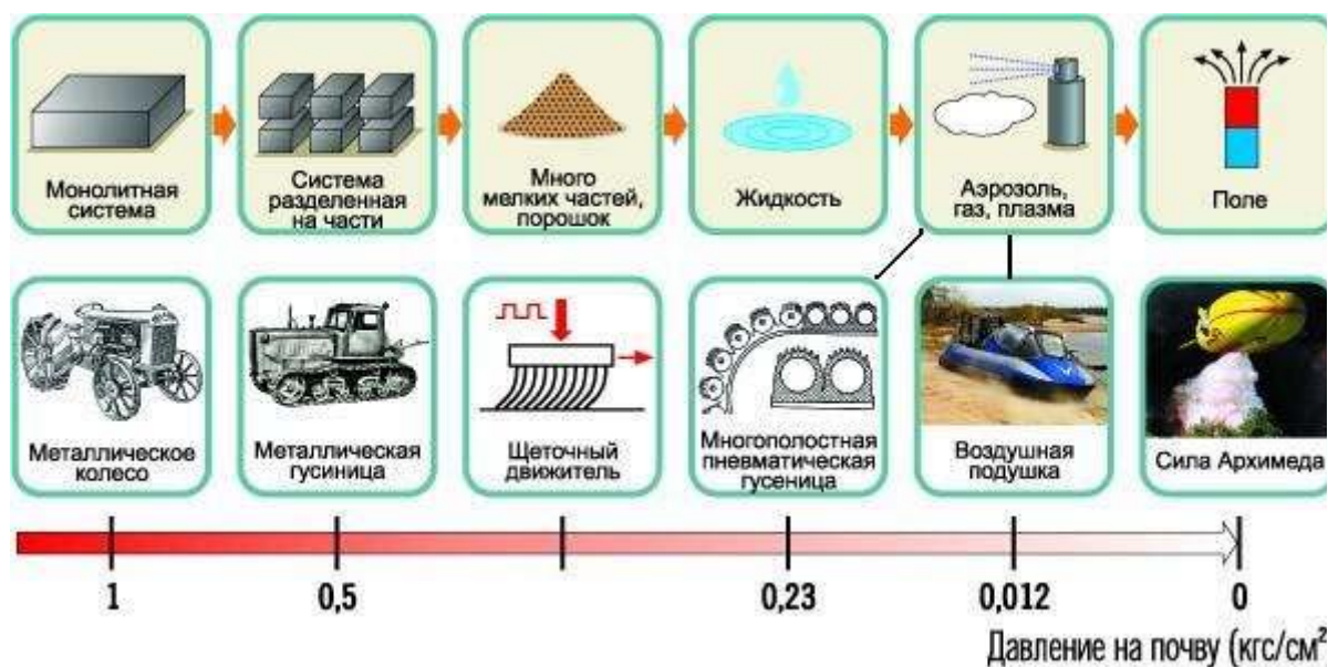
Рис. 12. Развитие двигателя по линии увеличения степени дробления
