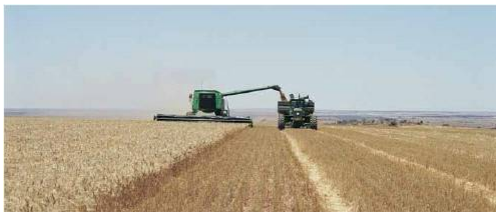
Рис.14. Выгрузка зерна комбайном в грузовик,двигающийся по соседней технологической колее [21]
