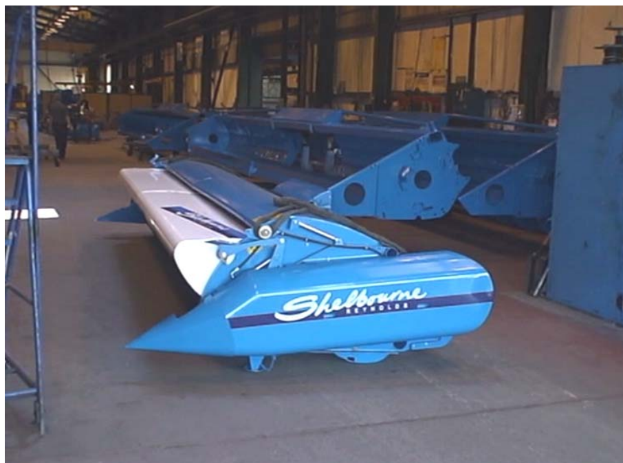
Рис. 9. Модифицированная жатка Shelbourne Reynolds для комбайна Нива.
