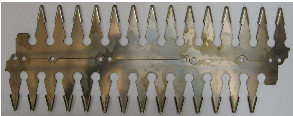
Рис. 6. Секции, «вжатые» друг в друга вспомогательными частями.
